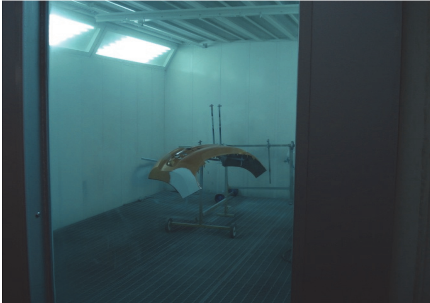
Сл.55а Комора за бојадисување и лакирање на делови од моторно возило
