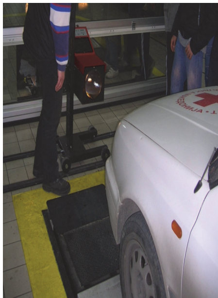
Сл. 43 Реглоскоп, а)изглед и б)контрола на усмереност на снопот светлина од фарот
