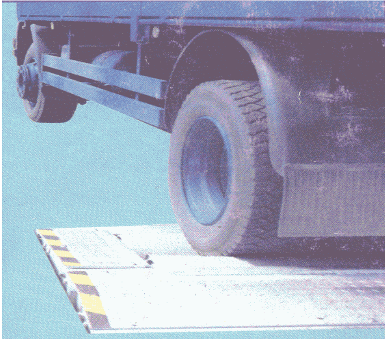
Сл. 65 Контрола на силата на сопирање со валци (Brekon)
